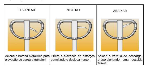
**LEVANTAR:** Posicionar o acionador manual na posição "levantar" e acionar o sistema hidráulico até a carga ficar elevada, sem haver o contato com o piso. **NEUTRO:** Para transportar o Carro Pantográfico até o ponto desejado, puxar o mesmo pela alavanca com o acionador manual na posição "neutro". **ABAIXAR:** Para abaixar a carga, basta colocar o acionador manual na posição "abaixar".
